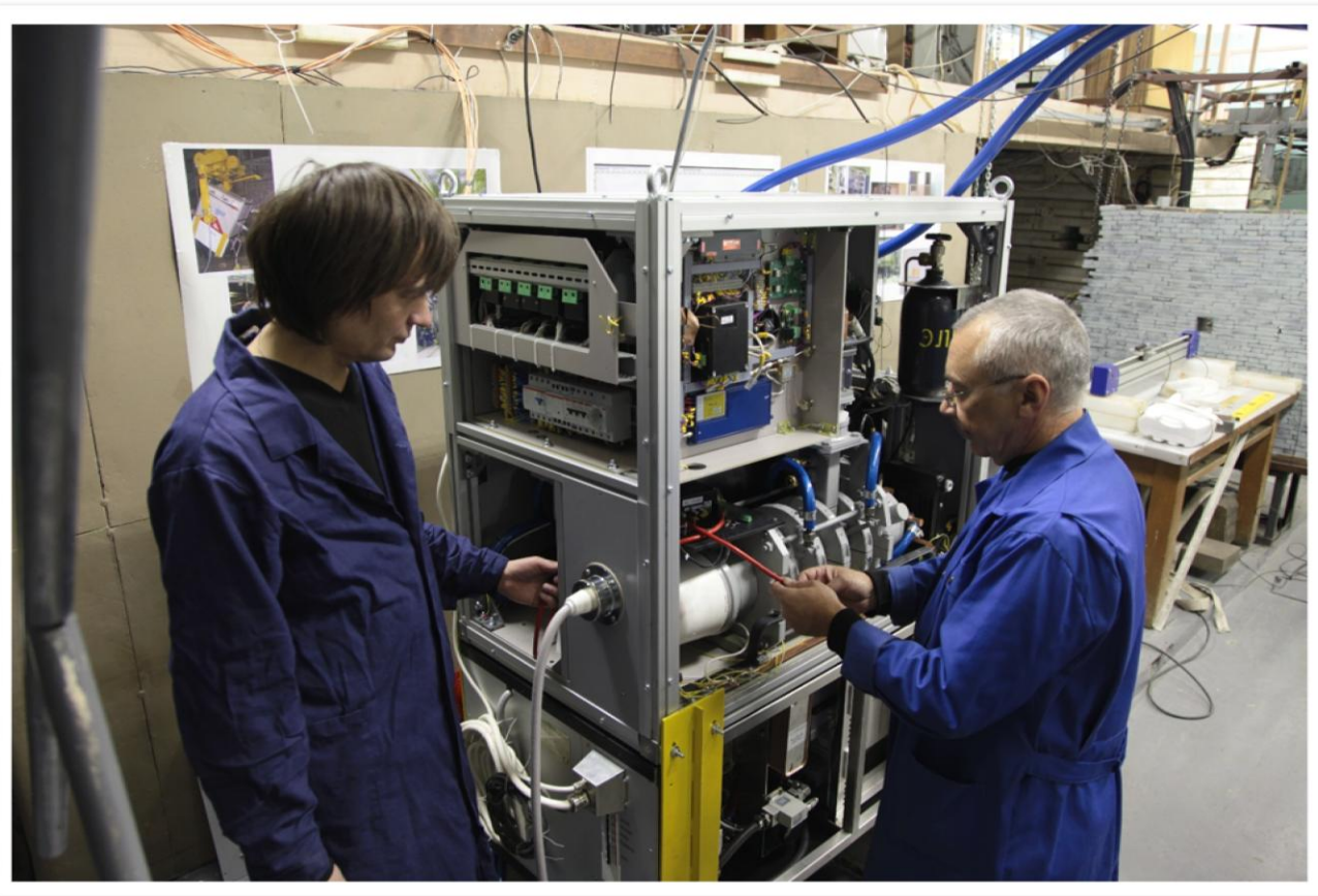
Компактный электронный ускоритель для радиографии
