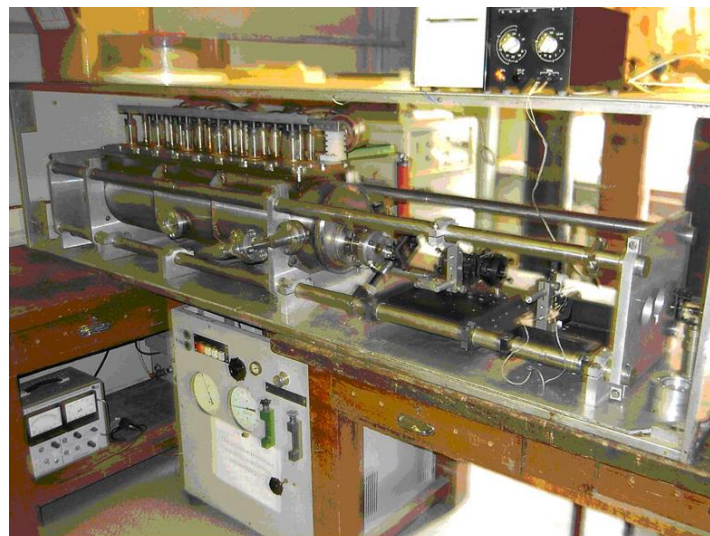
СО 2 лазер, 10.6 мкм, 1 Дж
